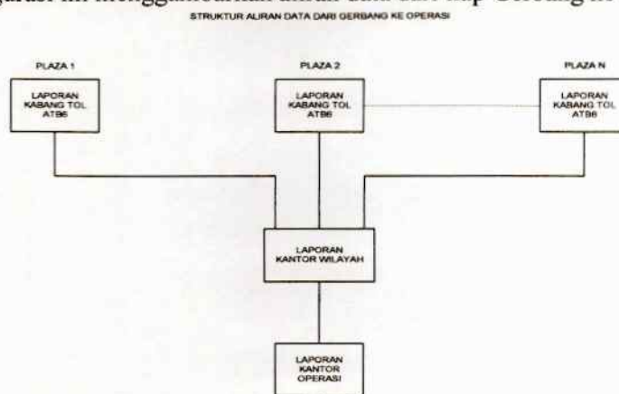
Gambar 9 : Struktur Aliran Data Gerbang ke Kantor Cabang
